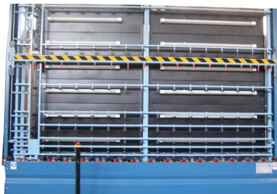
Le groupe d'assemblage ASS 1600 News permet l'accouplement en mode semi-automatique des composants permettant de réaliser un double vitrage : 1<sup>er</sup> verre – cadre intercalaire butylé – 2<sup>ème</sup> verre.
